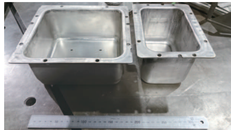
アルミ t2.5 深絞りプレス加工品(プレス加工 → 3次元レーザー)
